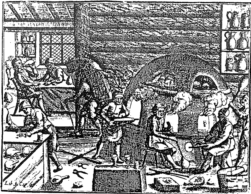
Abb. 9 a. Innenansicht einer Glashütte. Als Vorlage diente ein Holzschnitt in Georg Agricolas "De re metallica" (siehe Abb. 1!). Neu und insofern interessant sind insbesondere folgende Details: die Glasmacher sitzen bei ihrer Arbeit zum Teil; die Buckelkraxe des Glasträgers ist kein Holzgestell, sondern geflochten; die am Boden liegenden Zangen besitzen Gelenke; der Glasofen scheint in seinem oberen Teil zugleich als Glaskühlofen zu dienen; neu sind auch die Regale mit Glasprodukten rechts oben und im Hüttenwirtshaus links im Hintergrund. (Kupferstich aus: Wolff Helmhard von Hohberg, Georgica curiosa aucta, Teil 1, Nürnberg 1701. - Der sich an einen älteren Holzschnitt anlehende Stich diente seinerseits als Vorlage für ein Ölgemälde eines unbekannten Malers, Abb. in: Katalog der Sonderausstellung "Niederösterreich im Türkenjahr 1683" im Österreichischen Zinnfigurenmuseum im Schloß Pottenbrunn 1983, St. Pölten 1983, nach S. 64.)
